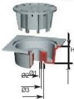
Sifon para desague PP (salida externa) PP trapped floor drain (external outlet)
